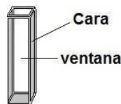
Fig. 3 Diferentes celdas de plástico y partes que la componen.
