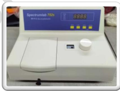
Fig. 2 Espectrofotómetro UV-Vis, 200~960nm de absorción atómica. Marca: SHLG
