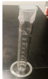
Fig. 4 y 5 Taponamiento con parafilm
