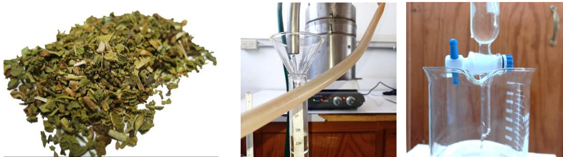
Figura 7. Material seco y equipo de acero inoxidable para el destilado de arrastre con vapor.
