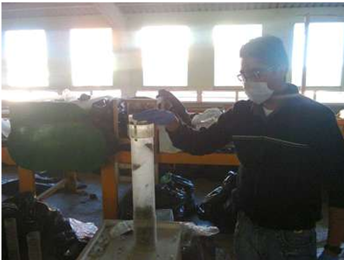
Figura 1.- Proceso de limpieza neumática de muestras de semillas de Pinus strobiformis mediante deflectores de aire en el laboratorio de CONAFOR Durango.
