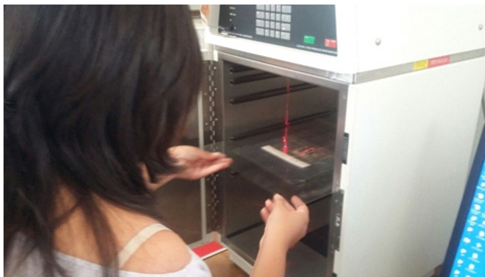
Figura 3.- Disposición y alineación equidistante de las muestras de semillas sobre las plantillas previo al análisis radiográfico.
