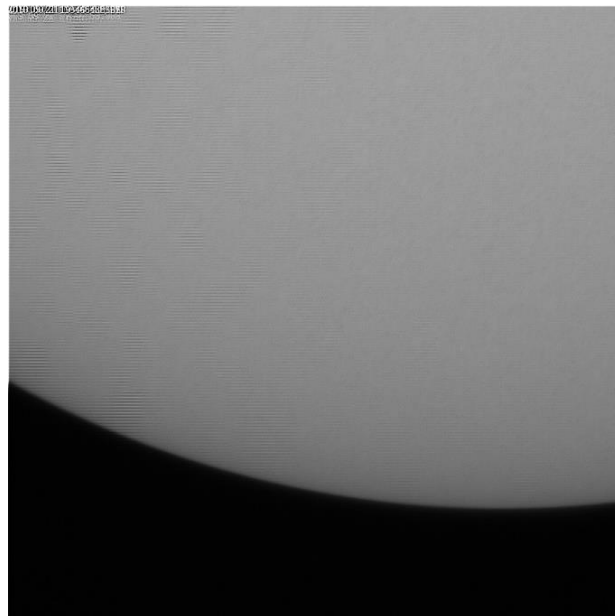
Figura 6. Imagen obtenida con telescopio de 1250 mm de distancia focal con filtro de polímero y cámara con sensor CCD
