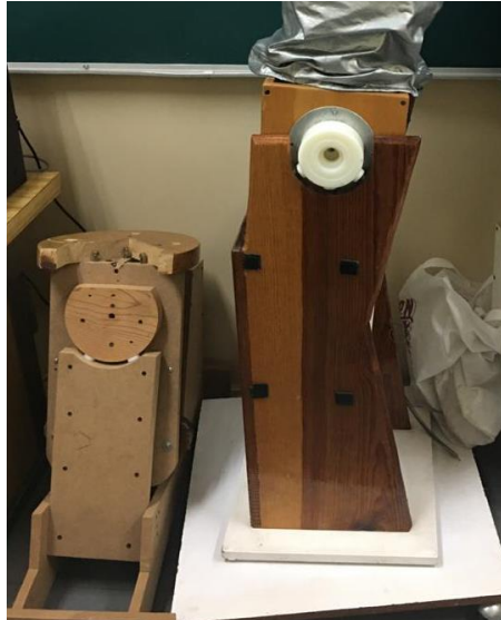
Ilustración 21. Montura ecuatorial (izquierda) y montura Dobson (derecha).
