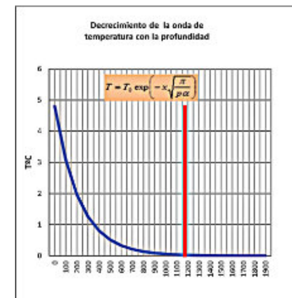
Fig. 13. Disipación de la onda de temperatura del agua con la profundidad. La línea vertical marca la distancia desde el origen en que se anula totalmente el cambio de temperatura.
