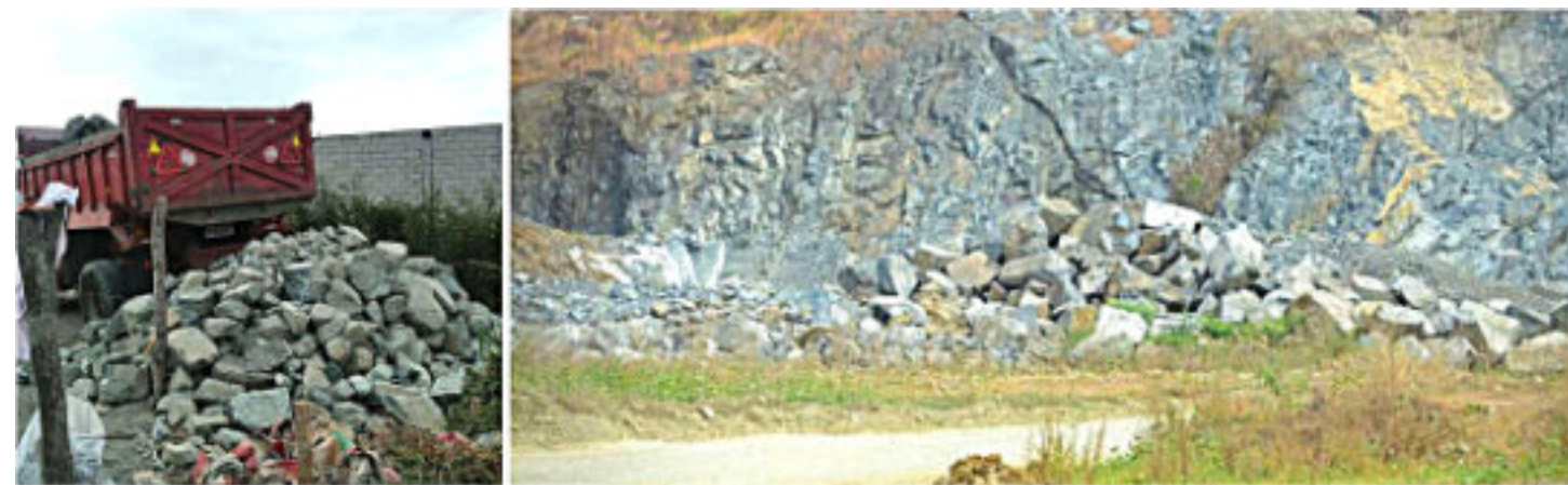
Figura 6. Faenas de extracción y acopio de piedra verde (o “piedra azul base”) en canteras del área de Guayaquil. A la izquierda, bloques recién extraídos y fragmentados listos para su transporte ( www.instagram.com/canterasexpress ); a la derecha, frente de cantera ubicada en la zona de La Aurora, en Daule, con afloramientos de rocas verdosas de alta competencia utilizadas como material base para obras civiles, infraestructura vial y, en menor medida, como piedra ornamental ( https://www.expreso.ec/guayaquil/daule-malestar-canteras-crece-tregua-aurora-171854.html )
