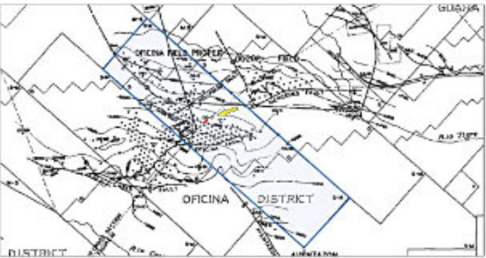
Figura 7. Mapa geológico-estructural del campo Oficina, indicando la localización del pozo descubridor Oficina No. 1 (OG-1), la red de fallas y los primeros pozos de desarrollo. El recuadro azul (parcela) y la flecha fueron incorporados por el autor para resaltar la localización del pozo descubridor (Modificado de Hedberg, 1947).
